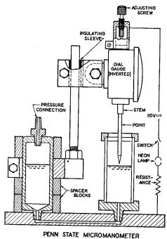
Fig. 16-4. Penn State Micromanometer.
