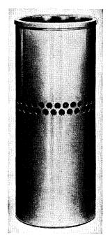
Fig. 17-7. Cylinder Liner.
