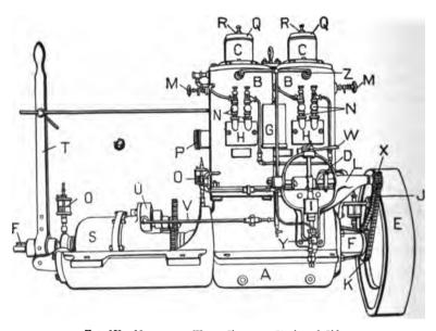
Fig. 129.—MEITZ AND WEISS ENGINE; Starboard Side. (Paragraph 246)
