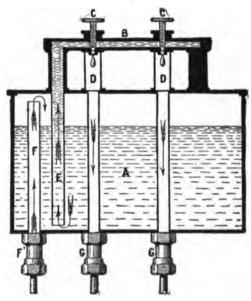
FIG. 146.—TYPICAL FORCE-FEED LUBRICATOR, OPERATING BY AIR OR GAS PRESSURE. INSTEAD OF A PUMP.
